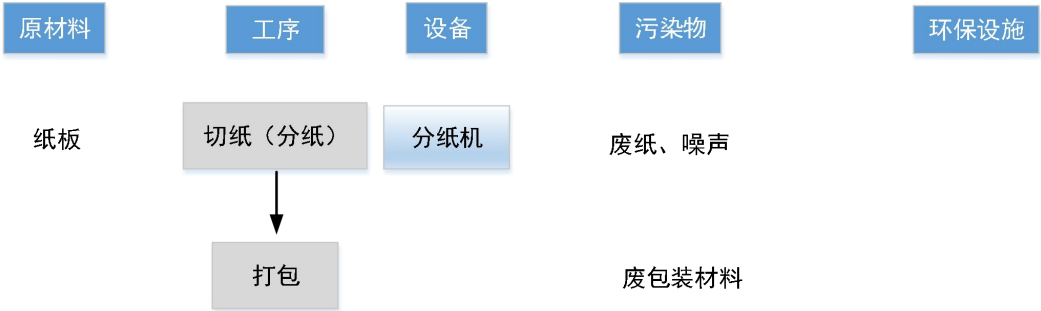
图 2-3 平卡生产流程图
