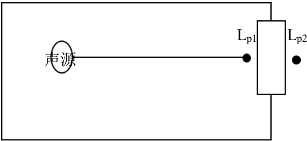
图 4-2 室内声源等效为室外声源图例
